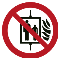
Aufzug im Brandfall nicht benutzen
